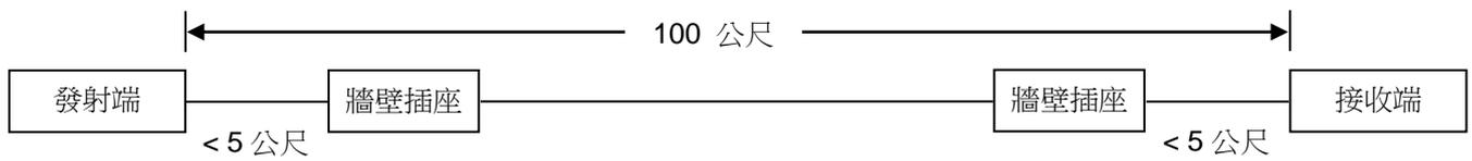
10/100Mbps Ethernet 端連接網路設備，僅需使用一般 CAT.5e 網路線即可，傳輸距離最遠可達 100 公尺
